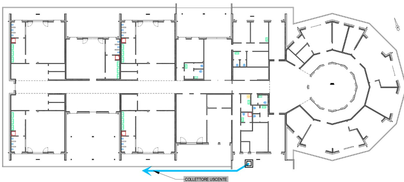
Figura 1: Evidenziazione degli apparecchi sanitari interni
