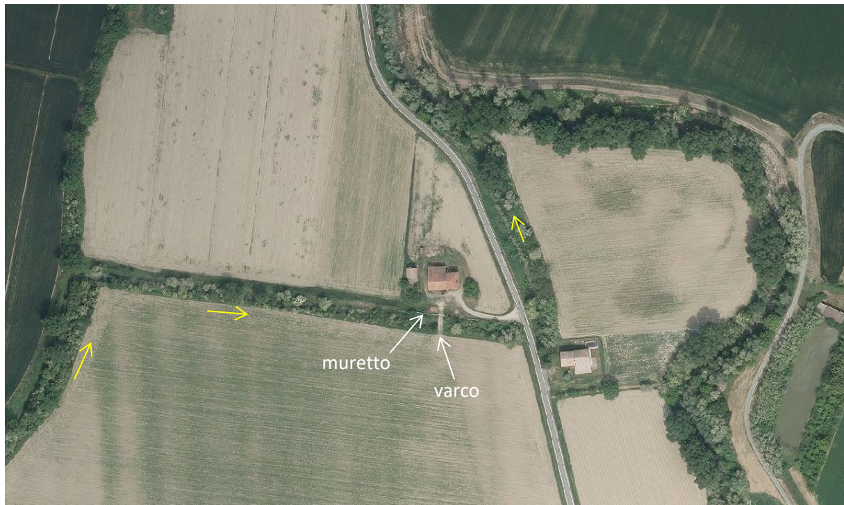
Figura 13 - Particolare del tratto terminale del canale Pizzabella e della sua immissione in Arda (freccie gialle); si notano il muretto di sovrizzo arginale e il varco in esso presente.
