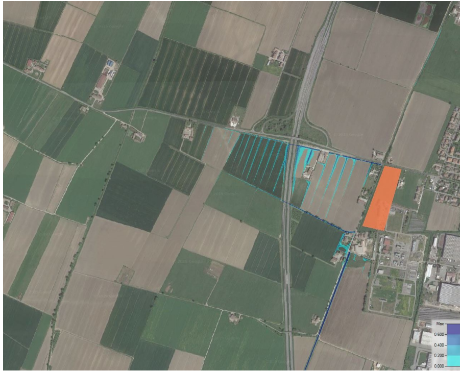
Figura 25 - Particolare delle aree allagate per T=50 anni in corrispondenza della zona della modifica 3 (modifica viabilità) della Variante 2019 al PRG.
