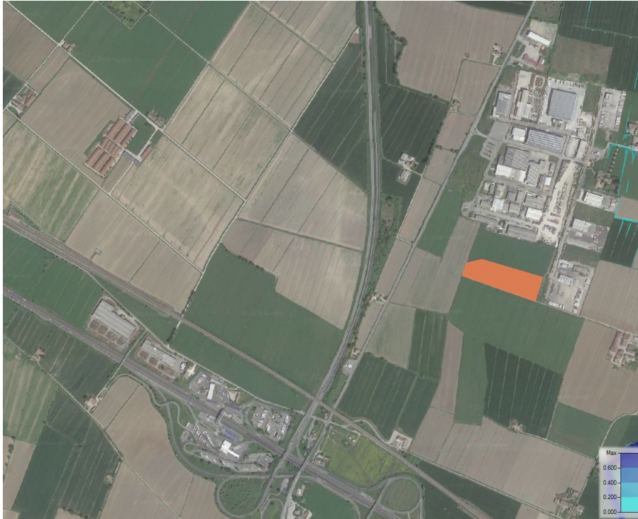
Figura 27 - Particolare delle aree allagate per T=20 anni in corrispondenza della zona della modifica 1 (Finedil) della Variante 2019 al PRG.
