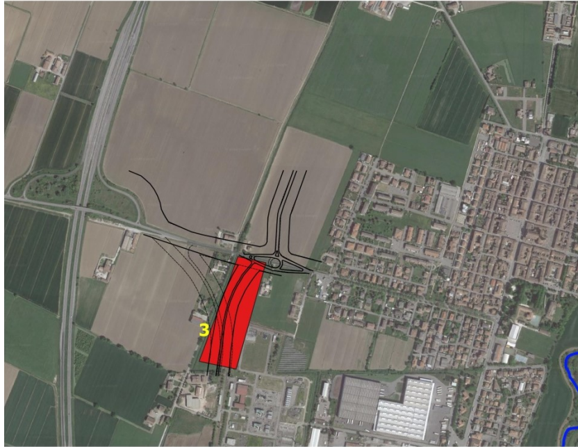
Figura 5 - Modifica viabilistica. In linea continua il tracciato modificato dello svincolo previsto dalla Variante 2019 al PRG, in linea tratteggiata quello previsto dal PRG vigente.
